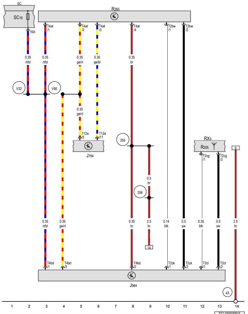
电子通讯信息设备 1 控制单元, 移动电话的双路信号放大器, 车顶天线, 带移动电话接口的储物箱, 保险丝架 C
